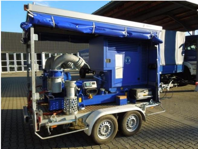
**Fahrzeugdaten:**Hersteller: BörgerBaujahr: 2007Gewicht: 2tAntriebsart: DieselmotorFörderleistung: 1400-5000 l/minBetriebsdruck: 1–4 bar
