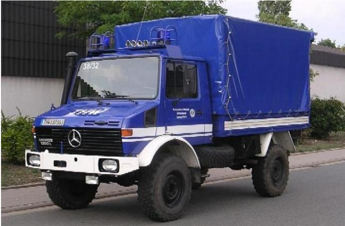
**Fahrzeugdaten:**Typ: Daimler-Benz Unimog 1300LBaujahr: 1982Leistung: 110 PSGesamtgewicht: 7,25 tNutzlast: 2,5 tSitzplätze: 1+2Kraftstoff: DieselWatttiefe: 1,2 m**Beladung:**
