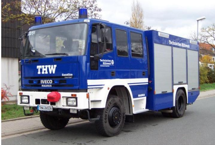
**Fahrzeugdaten:**Typ: Iveco FF 140 E24WBaujahr: 2006Leistung: 240 PSZul. Gesamtgewicht: 14,0 tKraftstoff: DieselSitzplätze: 1+8**Beladung:**Licht:
